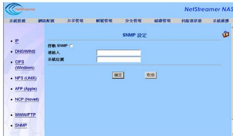
系統管理者可以在這裡指定是否要啓動 SNMP 功能，欲啓動 SNMP 服務，請選取「啓動 SNMP」，並於「連絡人(Contact)」欄位中，描述系統管理者的姓名，並於「系統位置(Location)」欄位中，描述此 NAS 伺服器所在的系統位置，再按「**確定**」。
