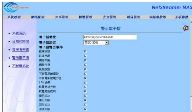
NAS 2120 可以在重要狀況發生時，寄送郵件通知系統管理者。請於此頁填入收件者郵件地址的資料，NAS 系統將在錯誤狀況發生時，即時地把狀況以電子郵件通知系統管理員，以便其隨時掌握伺服器狀況，確保系統的安全。
