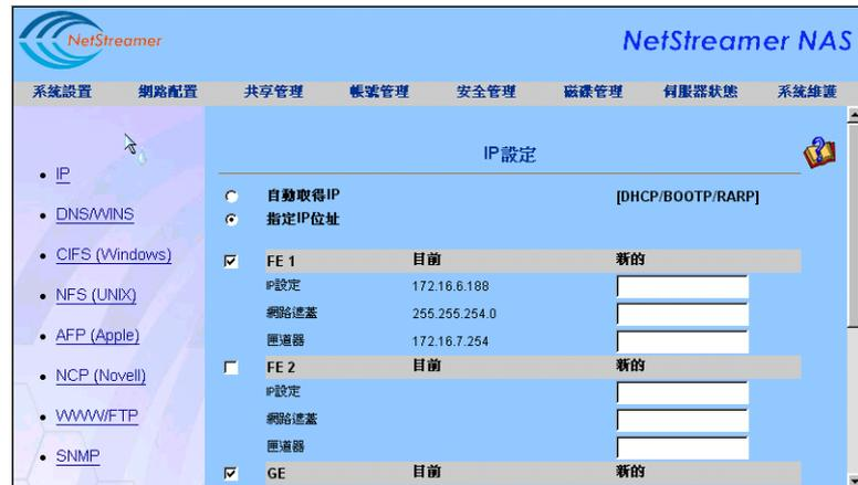
如果區域網路內有 DHCP 伺服器自動設定網路組態，可點選「自動取得一個 IP（Obtain an IP Automatically）」，若否，請指定 IP 地址（Specify IP Address）。
