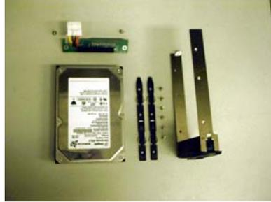
2. 細將磁碟 40-pin 端子及 4-pin Power 端子固定於轉接板。
