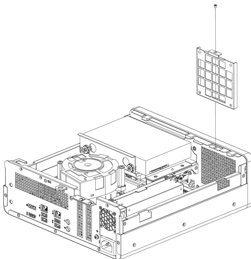
図 4.21 フィルターカバーの取り外し
