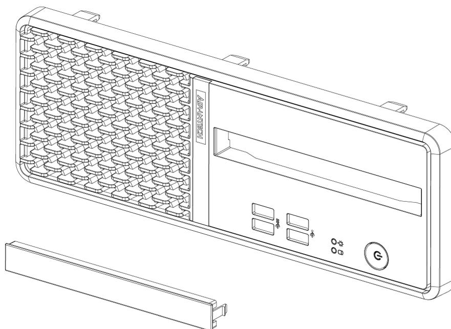
図 4.16 前側プラスチックスリム ODD カバーの取り外し
