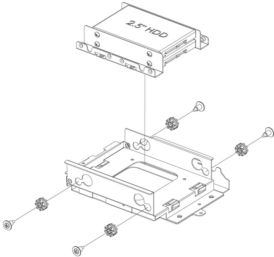
図 4.12 2.5 インチドライブ 2 台の取り付け
