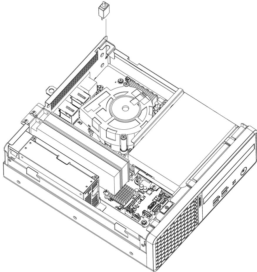
図 4.20 シャーシイントルージョンスイッチケーブルの取り付け
