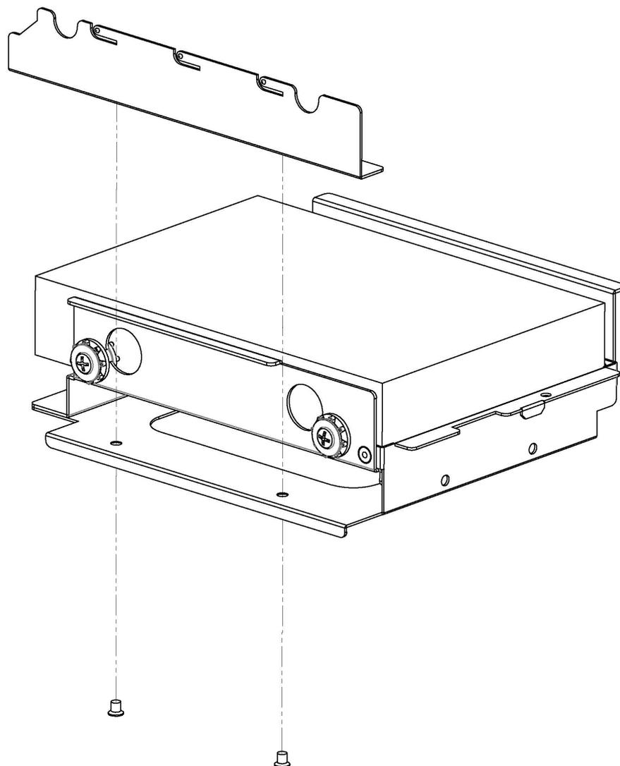
図 4.17 ドライブベイ ODD カバーの取り外し
