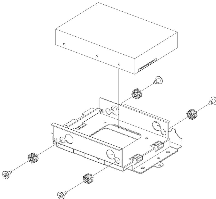
図 4.10 3.5 インチ HDD ドライブの取り付け
