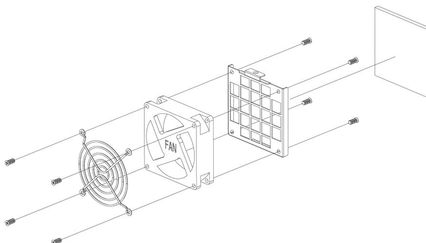
図 4.22 ファン、フィルターの取り付け
