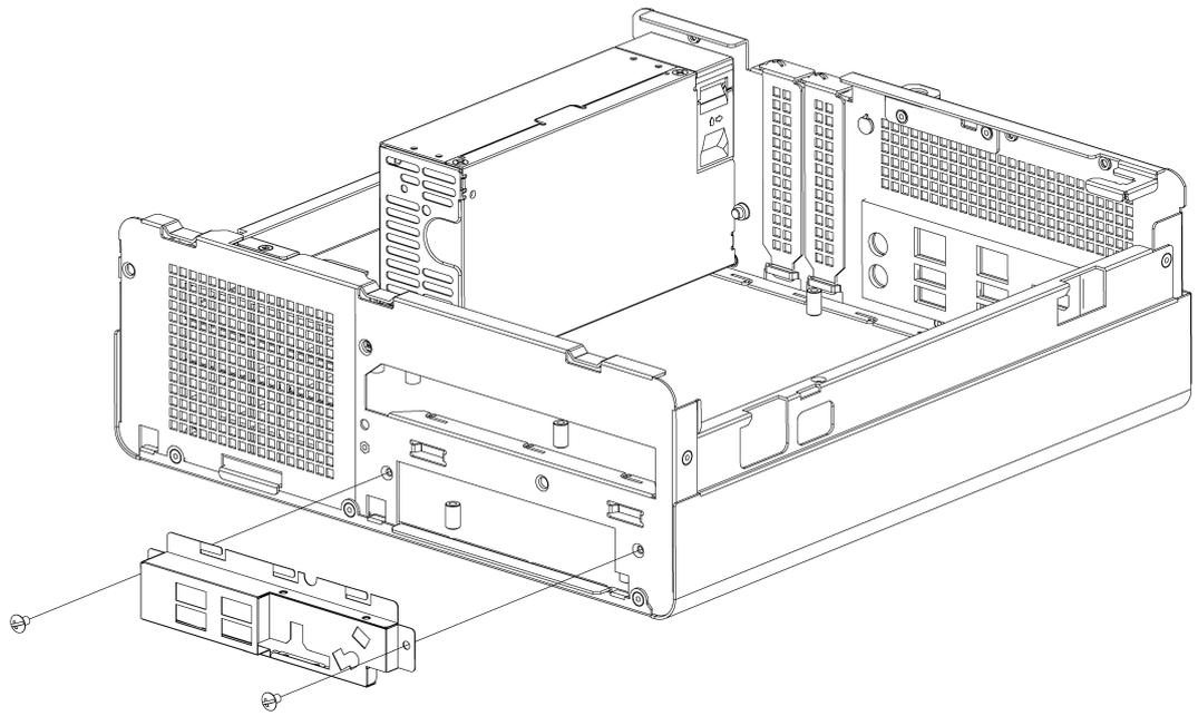
図 4.8 前側 I/O カバーの取り外し
