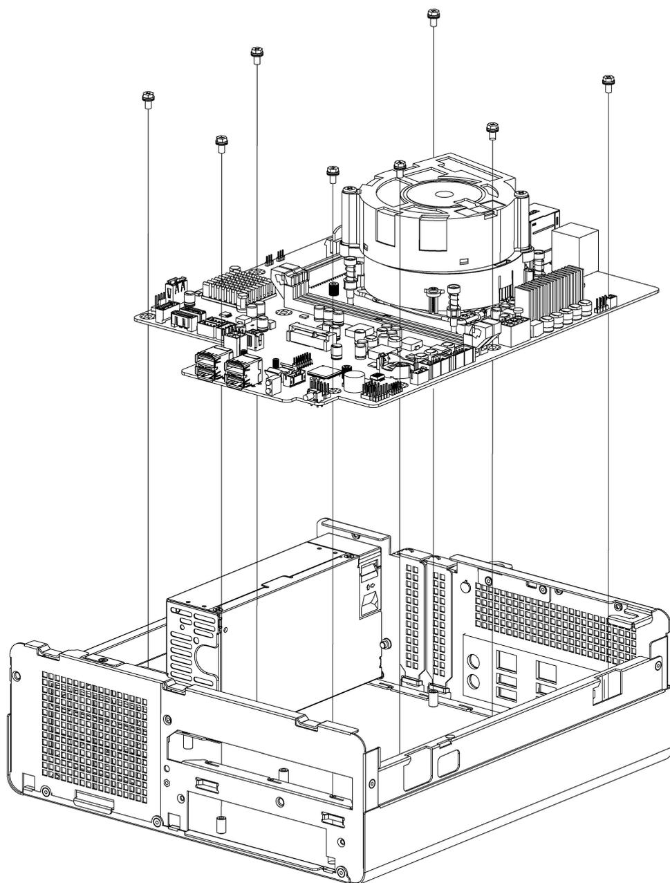
図 4.9 マザーボードの取り付け
