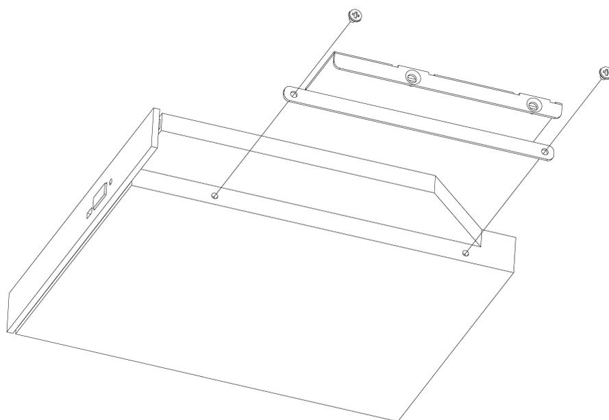
図 4.15 スリム ODD ブラケットの組み立て
