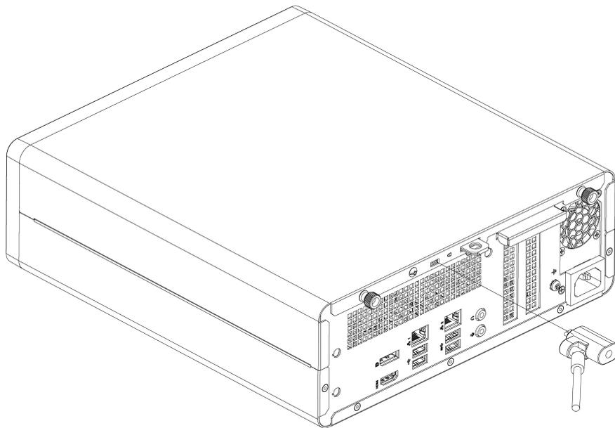
図 4.23 Kensington™ セキュリティロックケーブルの取り付け
