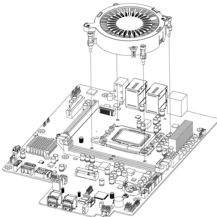
図 4.2 CPUクーラー/ヒートシンクの組み立て
