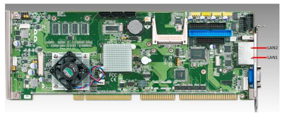
Figure 2.11 LAN RJ45 connector (LAN1/LAN2)
